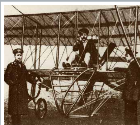
«Святогор» – русский самолёт, прототип бомбардировщика, строился под наблюдением Н.Р. Лобанова, 1916 г. Оснащался двумя деревянными винтами диаметром 6 метров
