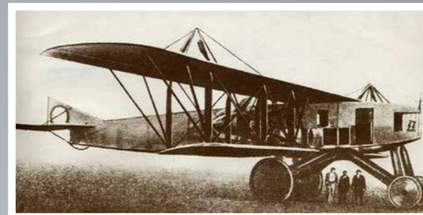
«Святогор» – русский самолёт, прототип бомбардировщика, строился под наблюдением Н.Р. Лобанова, 1916 г. Оснащался двумя деревянными винтами диаметром 6 метров
